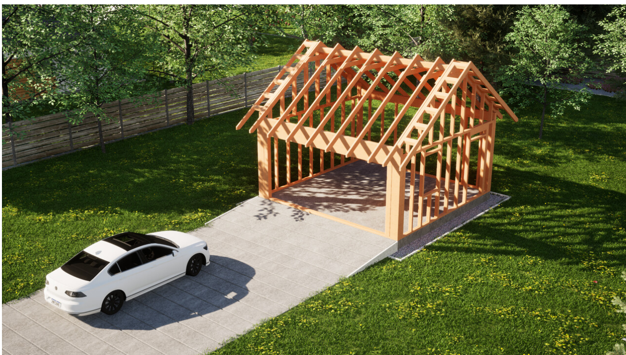
Widok konstrukcji: Garaż ERDOL G2 - Wersja prawa - Układ kalenicy równoległy z dachem dwuspadowym o kącie nachylenia 35 stopni
