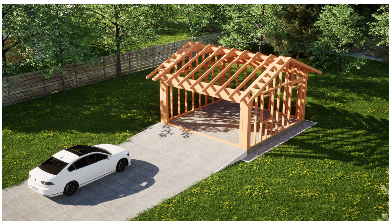
Widok konstrukcji: Garaż ERDOL G2 - Wersja prawa - Układ kalenicy równoległy z dachem dwuspadowym o kącie nachylenia 25 stopni
