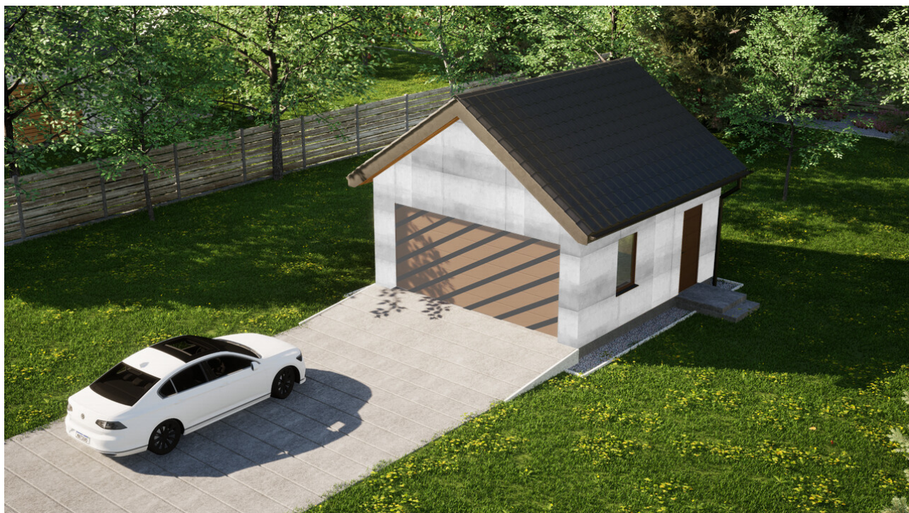
Garaz ERDOL G2 - Wersja prawa - Układ kalenicy prostopadły z dachem dwuspadowym o kącie nachylenia 35 stopni - Bez bramy - Złoty dąb
