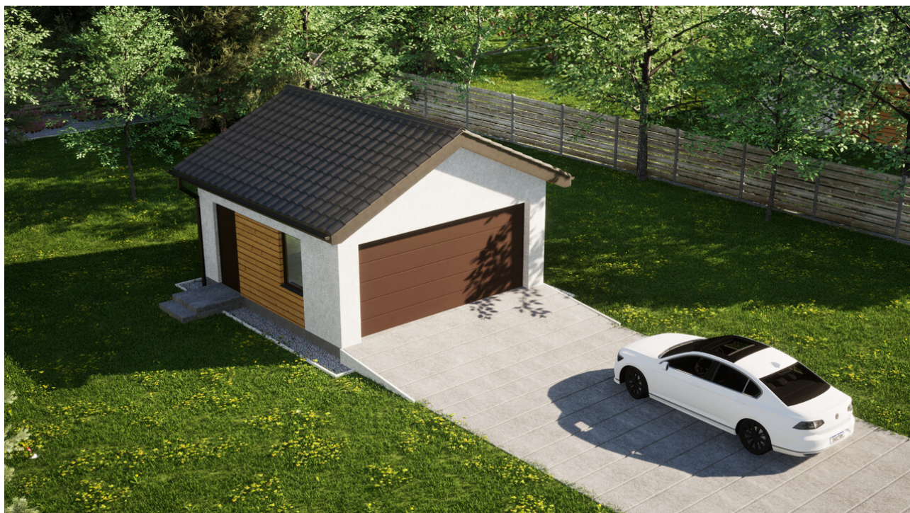
Garaż ERDOL G2 - Wersja lewa - Układ kalenicy prostopadły z dachem dwuspadowym o kącie nachylenia 25 stopni - Brama segmentowa z napędem IO, sterowana pilotem - UniPro WIŚNIOWSKI - Orzech
