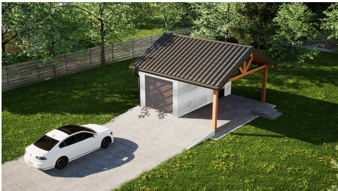
Garaz ERDOL G1W - Wersja prawa - Układ kalenicy równoległy z dachem dwuspadowym o kącie nachylenia 25 stopni - Bez bramy - Orzech
