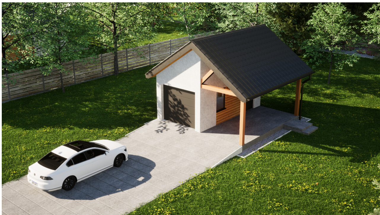
Garaz ERDOL G1W - Wersja prawa - Układ kalenicy prostopadły z dachem dwuspadowym o kącie nachylenia 35 stopni - Brama segmentowa z napędem IO, sterowana pilotem - UniPro WIŚNIEWSKI - Antracyt
