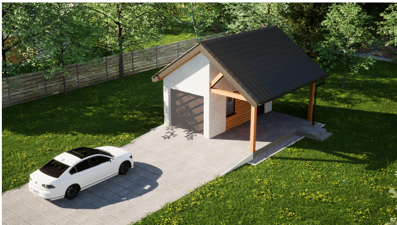
Garaż ERDOL G1W - Wersja prawa - Układ kalenicy prostopadły z dachem dwuspadowym o kącie nachylenia 35 stopni - Bez bramy - Orzech
