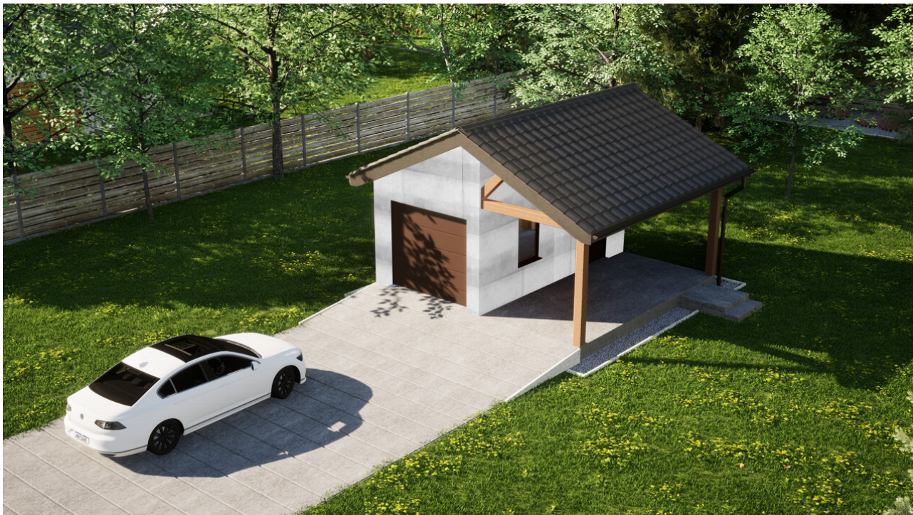
Garaz ERDOL G1W - Wersja prawa - Układ kalenicy prostopadły z dachem dwuspadowym o kącie nachylenia 25 stopni - Brama segmentowa z napędem IO, sterowana pilotem - UniPro WIŚNIEWSKI - Orzech
