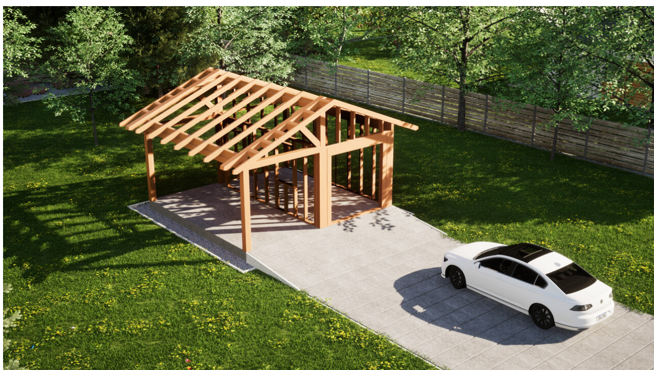
Widok konstrukcji: Garaż ERDOL G1W - Wersja lewa - Układ kalenicy prostopadły z dachem dwuspadowym o kącie nachylenia 25 stopni
