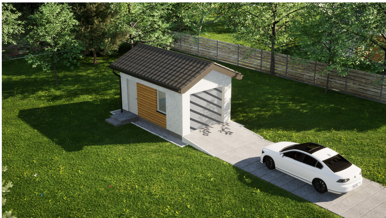
Garaz ERDOL G1 - Wersja lewa - Układ kalenicy prostopadły z dachem dwuspadowym o kącie nachylenia 25 stopni - Bez bramy - Białe
