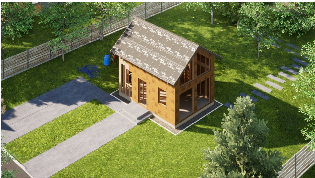
Projekt ERDOL Mini - gotowa konstrukcja - Dach z okapem - Bez okien i drzwi - Elewacja z płytą STEICO Protect 60mm - Bez dachu - Bez zamkniętych ścian
